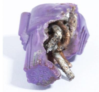
Connecteur de fil conçu pour le câblage en cuivre uniquement
